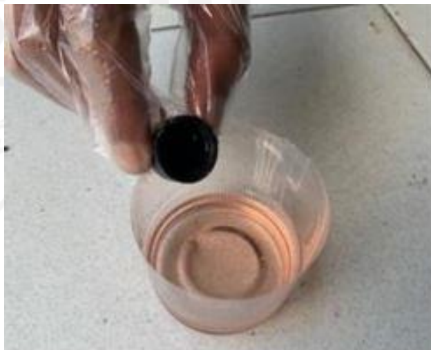
Gambar 4- 5 Proses pencampuran resin dan katalis
