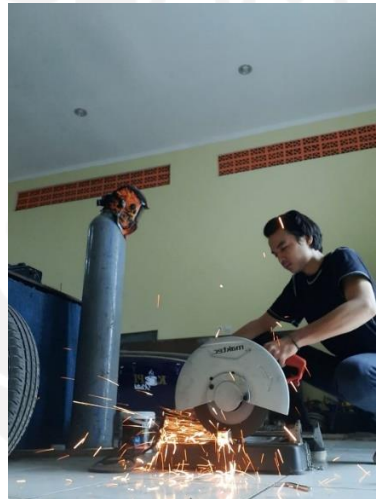
Gambar 4- 7 Proses Pemotongan Besi Hollow
