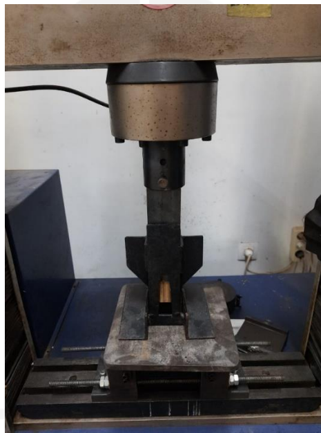
Gambar 4- 17 Pengujian Uji Kuat Rekat
