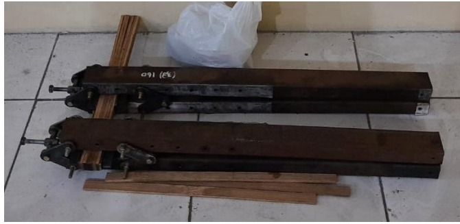
Gambar 4- 13 Hasil Penjepit Saat Menekan Bilah Bambu Posisi Vertikal
