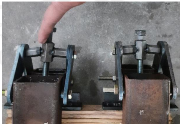
Gambar 4- 15 Kegagalan Pada Komponen Long Nut M8 dan M10
