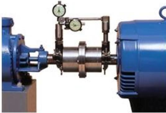
Gambar 2-12 Contoh *alignment* menggunakan dial indicator.
