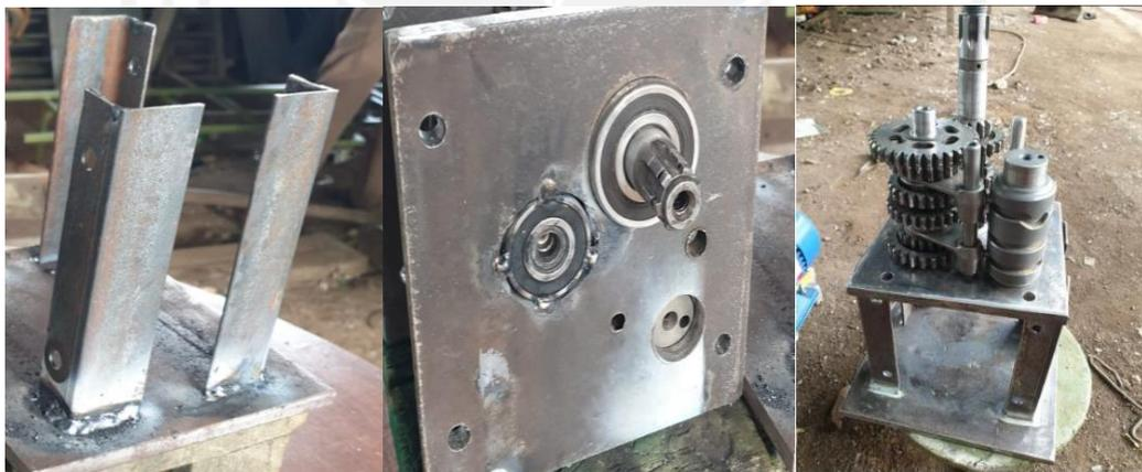
Gambar 4-1 Rangkaian gambar dari pengelasan, pembuatan lubang, dan pemasangan roda gigi
