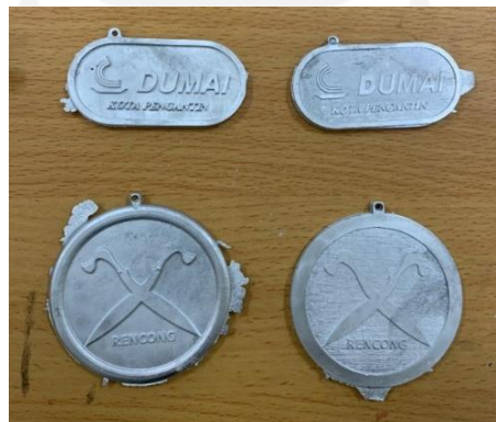
Gambar 4-19 Flash yang terjadi pada kecepatan putar 850 rpm
