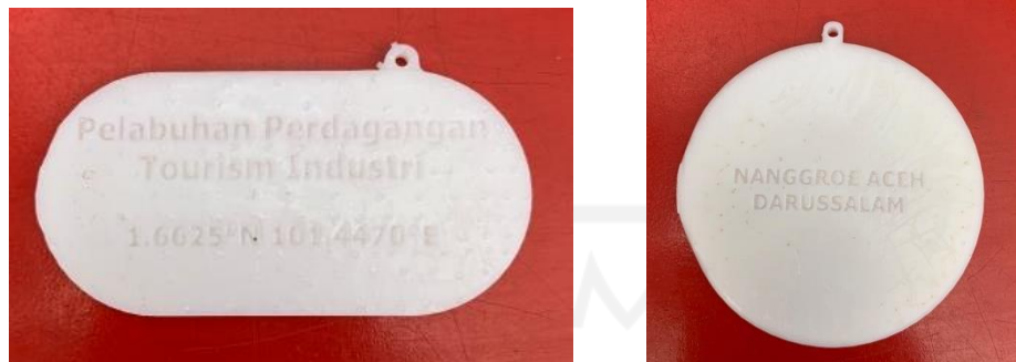
Gambar 4-2 Bagian belakang hasil cetakan 3d print resin
