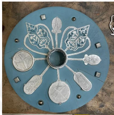
Gambar 4-8 Hasil pengecoran dengan jalur udara
