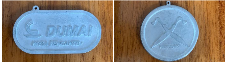
Gambar 4-21 Hasil pengecoran kecepatan putar 800 rpm
