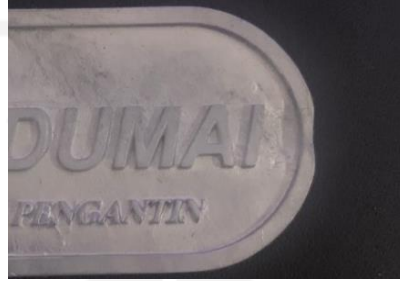
Gambar 4-18 Bagian yang kurang terisi pada desain Dumai (750 rpm)
