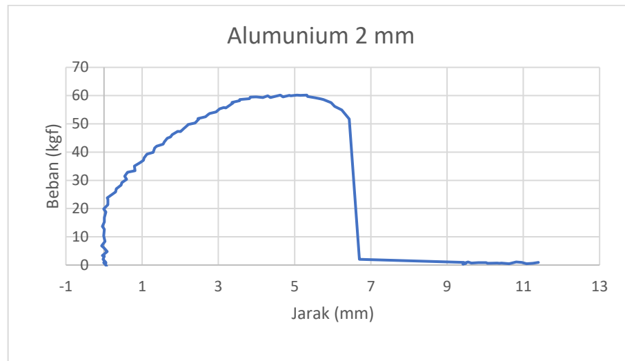
Gambar 4-6 Grafik Hasil Pengujian Tarik Spesimen Aluminium
