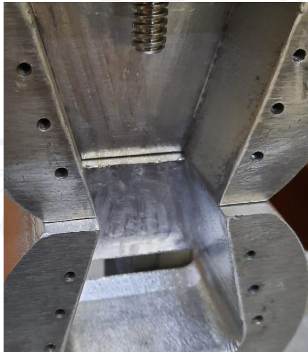
Gambar 3-3 Misalignment Pada Rangka Gripper
