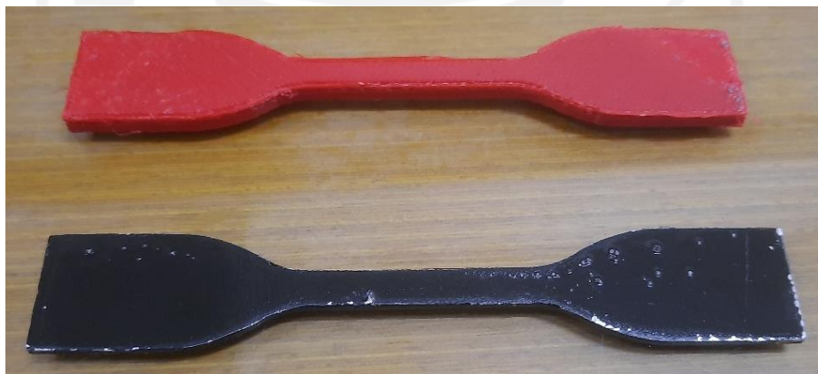
Gambar 3-22 Spesimen Pengujian Tarik Alumunium dan Plastik ABS
