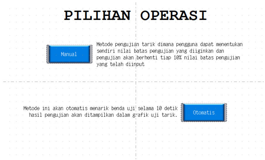
Gambar 3-15 Tampilan Menu Pilihan Pengujian (Otomatis/Manual)
