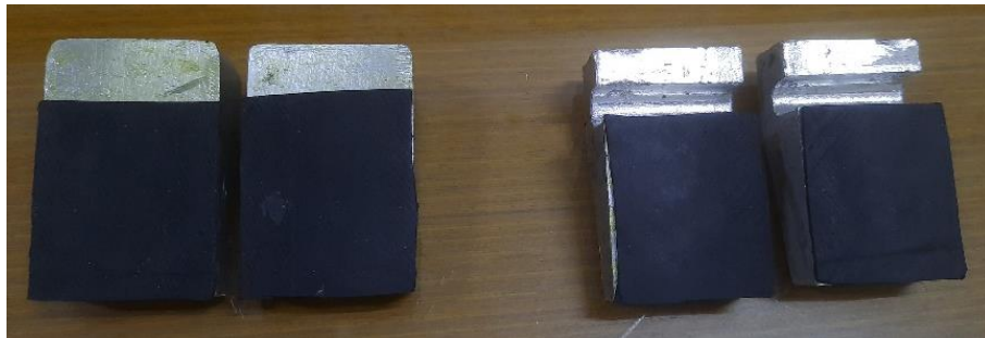
Gambar 4-3 Hasil Pelapisan Penjepit Gripper Atas dan Bawah
