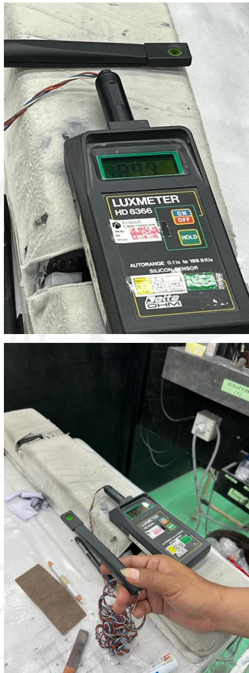
Gambar 5. 13 Tingkat Cahaya Pada QC Final Check PPR
