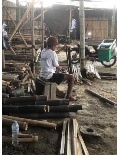
Gambar 4. 5 Proses Sisik Bambu
