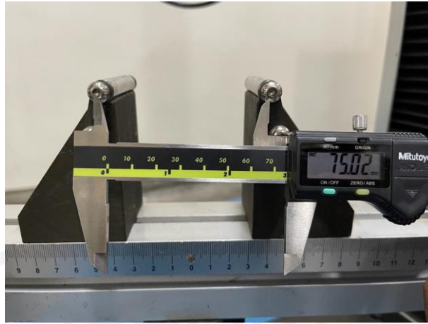
Gambar 3-32 Jarak tumpuan bending
