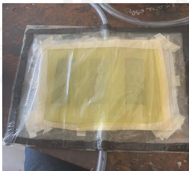
Gambar 3-27 Memasukan bahan kedalam vacuum bag
