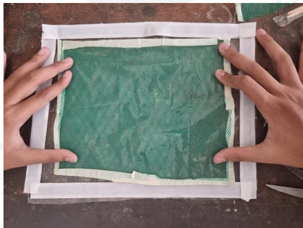
Gambar 3-23 Pemasangan kain strimin
