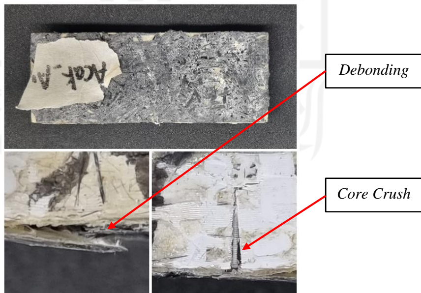
Gambar 4-4 Kegagalan spesimen carbon motif acak
