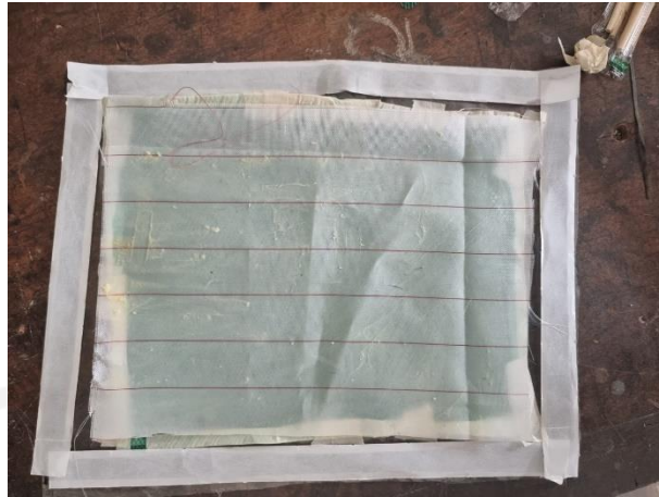
Gambar 3-24 Pemasangan peel ply
