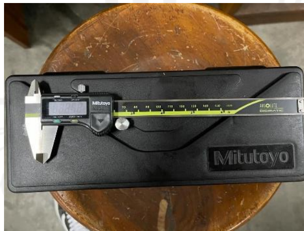
Gambar 3-6 Jangka sorong digital 0,02 mm
