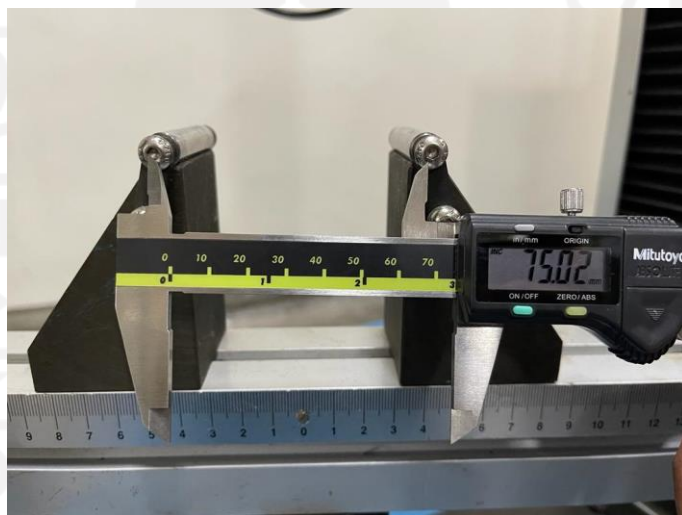
Gambar 3-31 Jarak tumpuan bending .
