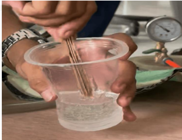
Gambar 3-29 Proses pencampuran resin dan katalis hardener .
