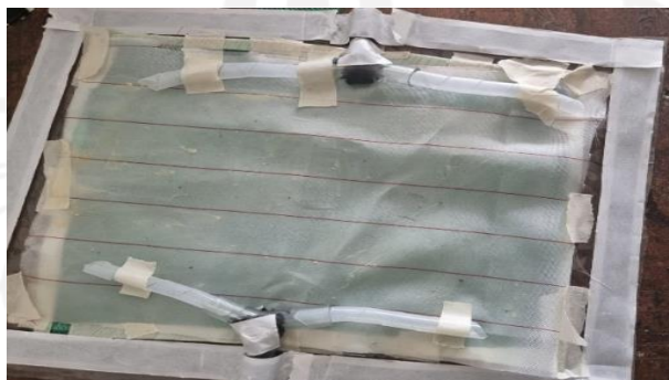
Gambar 3-26 Pemasangan selang infusion input dan output .
