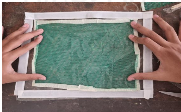
Gambar 3-24 Pemasangan jaring strimin.
