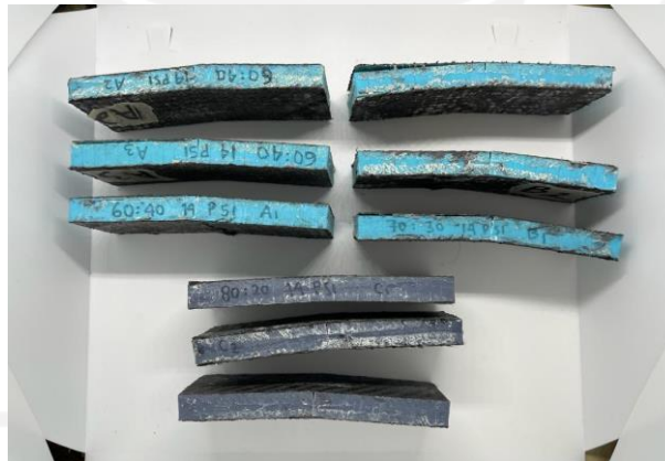
Gambar 3- 33 Spesimen perbandingan resin dan katalis setelah uji bending.
