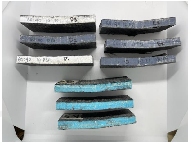
Gambar 3-34 Spesimen tekanan vacuum bag setelah uji bending.
