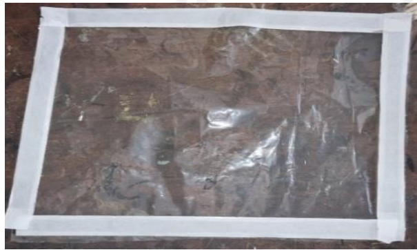
Gambar 3-23 Pemotongan vacuum bag dan sealant tape .
