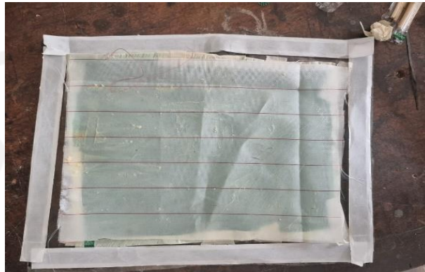
Gambar 3-25 Pemasangan kain peel ply .
