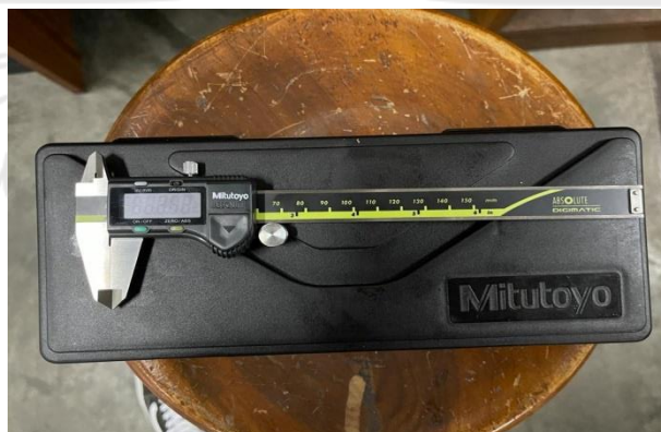
Gambar 3-8 Jangka sorong digital 0,02 mm
