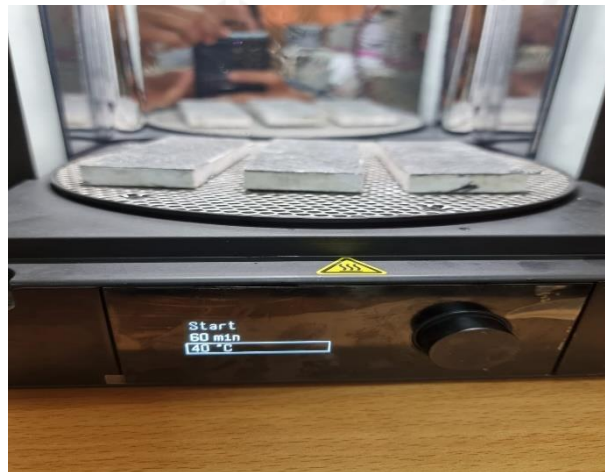
Gambar 2-8 Proses curing spesimen komposit sandwich
