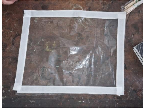
Gambar 3-8 Susunan plastik vakum dan butyl tape
