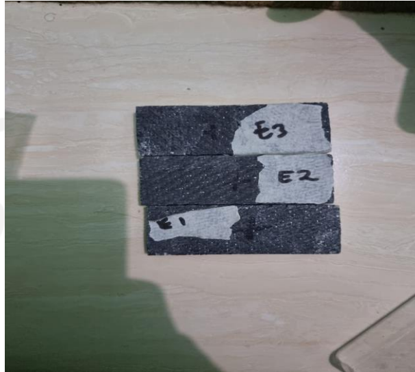
Gambar 3-14 Hasil setelah vakum infusion
