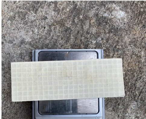
Gambar 3-6 Spesimen yang sudah diberi perekat dan selotip kertas
