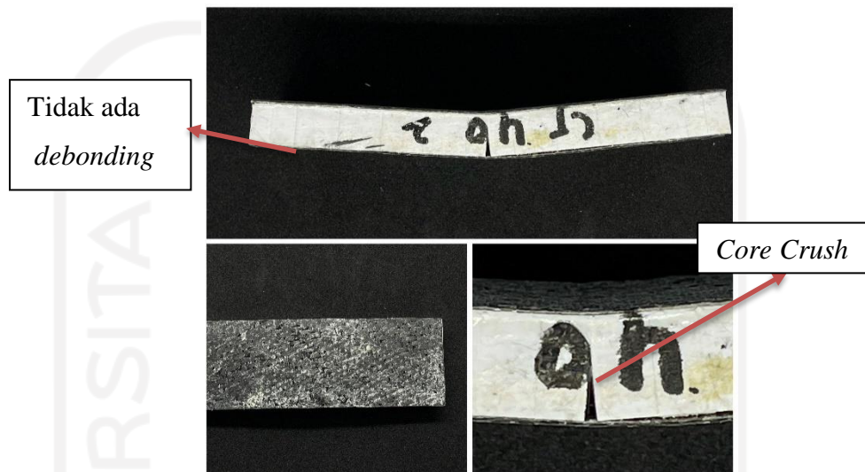
Gambar 4-13 Analisa Modus Kegagalan Spesimen Uji dengan Curing 40°C
