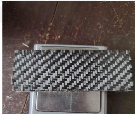
Gambar 3-7 Spesimen yang telah diolesi perekat( adhesive ) dan karbon
