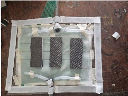
Gambar 3-9 Susunan Strimin, peel ply dan core di plastik vakum
