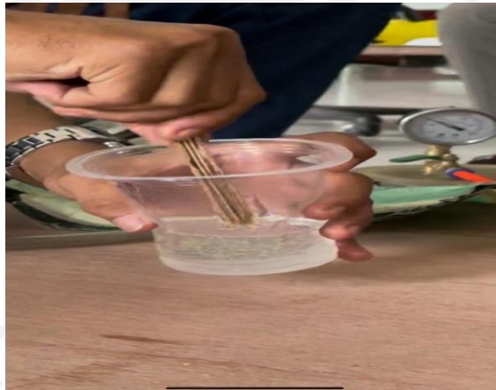
Gambar 3-11 Membuat campuran resin dan katalis
