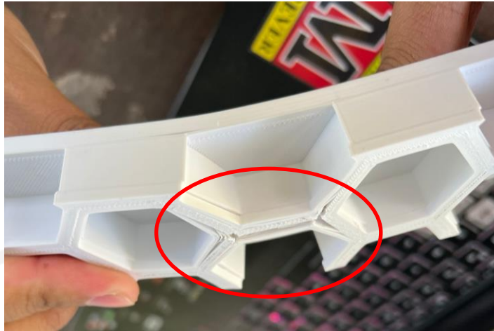
Gambar 4-6 Kegagalan Spesimen A30_5
