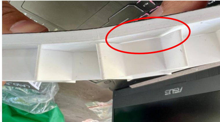
Gambar 4-12 Kegagalan Spesimen A30_1
