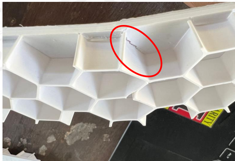
Gambar 4-11 Kegagalan Spesimen A20_1
