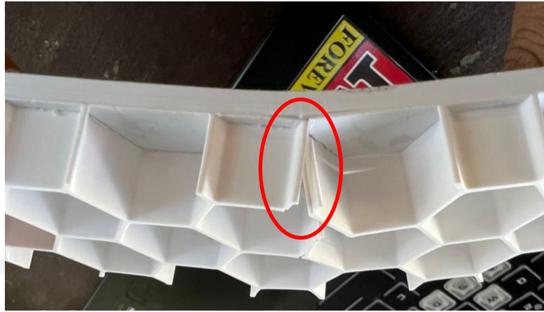
Gambar 4-9 Kegagalan Spesimen A20_1
