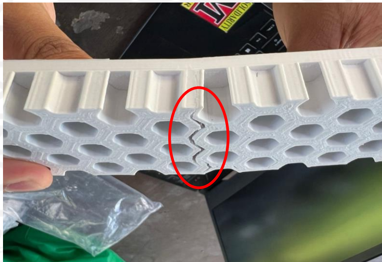
Gambar 4-5 Kegagalan Spesimen A10_5
