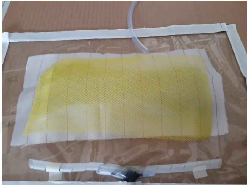
Gambar 3-29 Lapisan Spesimen, Serat Karbon, Peelply Dan Strimin
