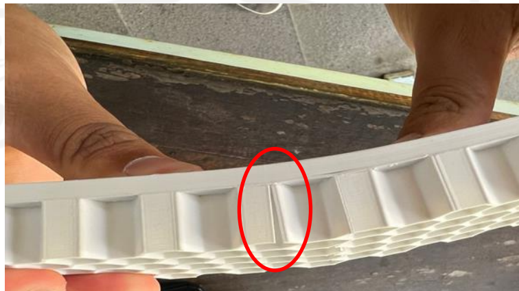
Gambar 4-8 Kegagalan Spesimen A10_1
