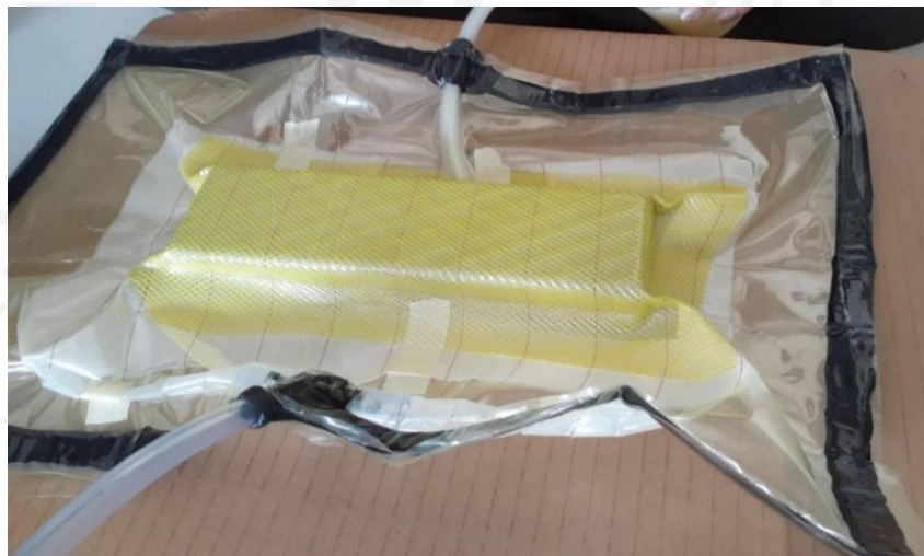
Gambar 3-30 Proses Pengecekan Kebocoran
