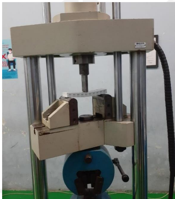
Gambar 4-1 Proses Pengujian Bending Spesimen
