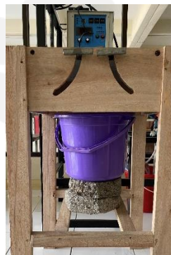
Gambar 3. 7 Proses pendinginan cepat media air
