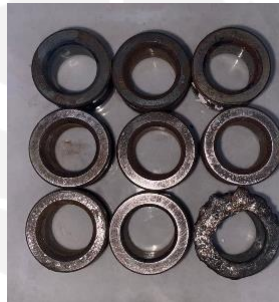
Gambar 4.1 Hasil spesimen setelah proses induction heating
