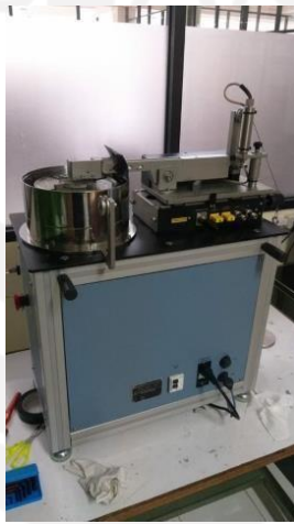
Gambar 3-16 Alat pengujian pin on disc
