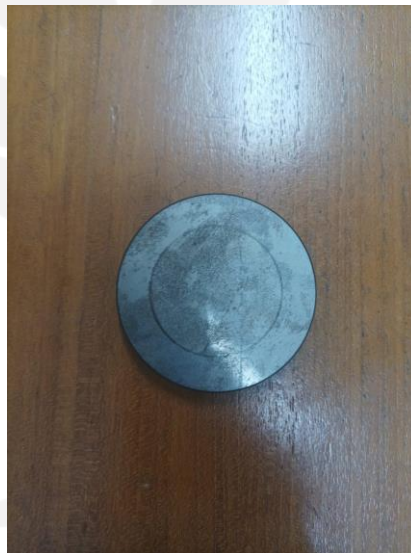
Gambar 3- 18 Spesimen uji tribologi ( pin )
