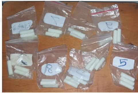
Gambar 3- 18 Spesimen uji tribologi ( pin )
