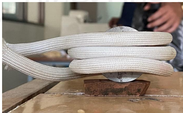
Gambar 3-27 Peletakan spesimen pada koil induksi
