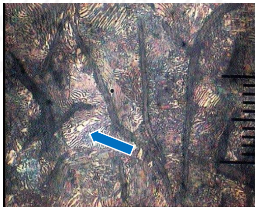
Gambar 4-26 Struktur Mikro B5' (lunak) Setelah Induksi (Titik 2)
