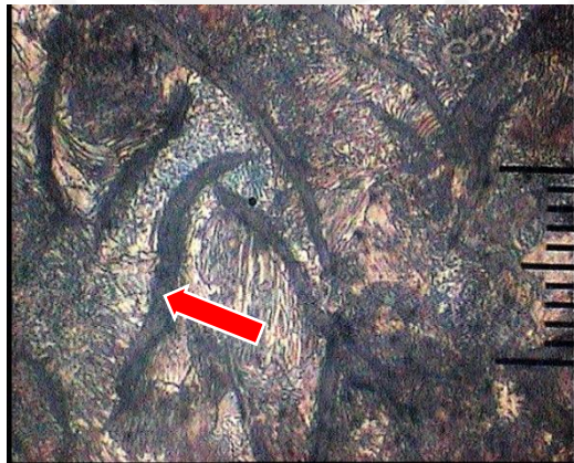
Gambar 4-25 Struktur Mikro B5' (lunak) Setelah Induksi (Titik 1)
