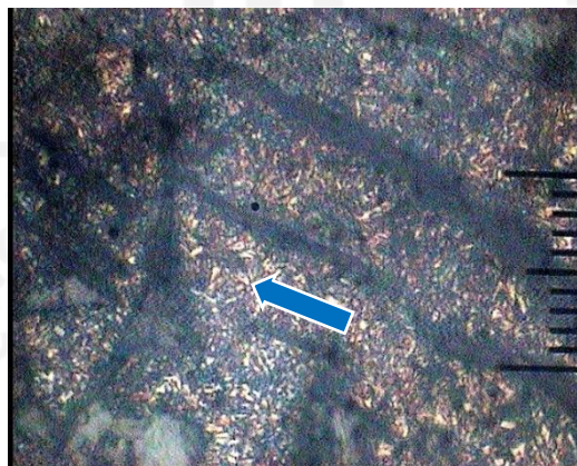
Gambar 4-23 Struktur Mikro B1' (keras) Setelah Induksi (Titik 2)
