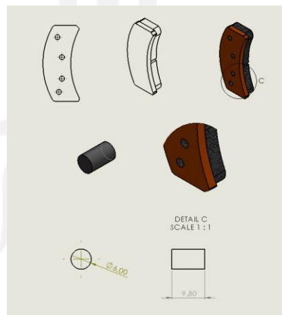
Gambar 3-11 Desain Pemotongan Kampas Rem Orisinal Toyota Agya
