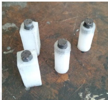
Gambar 3-13 Kampas Rem dan Holder Pin yang Sudah Terpasang
