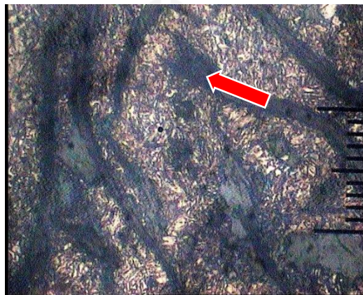
Gambar 4-22 Struktur Mikro B1' (keras) Setelah Induksi (Titik 1)
