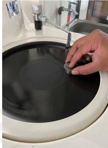
Gambar 3-14 Preparasi sampel uji kekerasan
