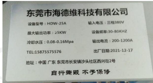
Gambar 3-25 Spesifikasi Mesin Pemanasan Induksi
