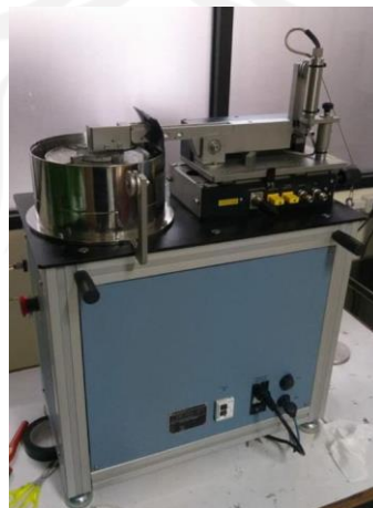
Gambar 3-16 Alat Pengujian Koefisien Gesek dan Aus ( Pin On Disc Tribometer )
