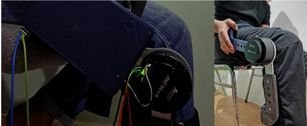
Gambar 4-2 Peletakan Motor RMD X6-S2 Pada Bagian Lutut
