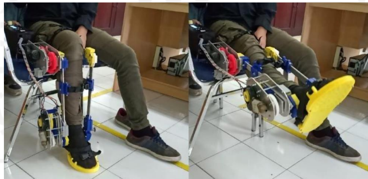
Gambar 2-5 Alat Bantu Rehabilitasi Kaki dengan Dua Derajat Kebebasan (Abror dan Sampurno, 2021)
