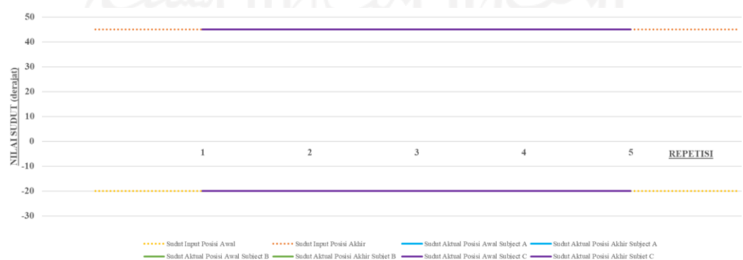
Gambar 4-19 Grafik Hasil Pengujian Sistem Kendali Lutut -20^\circ ke 45^\circ
