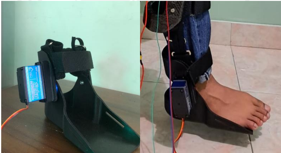
Gambar 4-3 Peletakan Motor SPT70HV Pada Bagian Ankle
