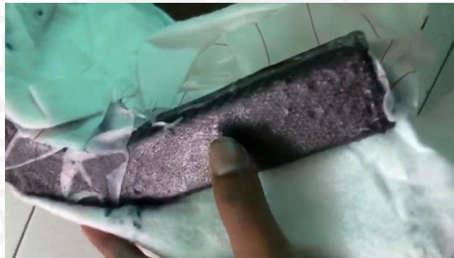
Gambar 4.12 Setelah proses vacuum bag
