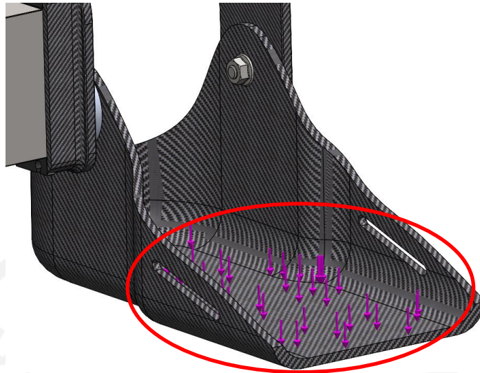
Gambar 3.25 Peletakan gaya pada simulasi bagian lutut
