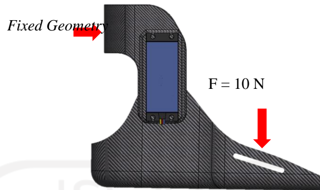
Gambar 3.23 Visualisasi simulasi tegangan bagian ankle
