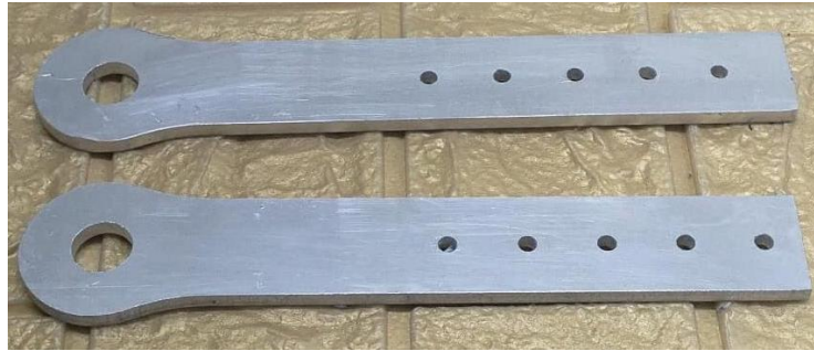
Gambar 4.29 Hasil plasma cutting yang tajam
