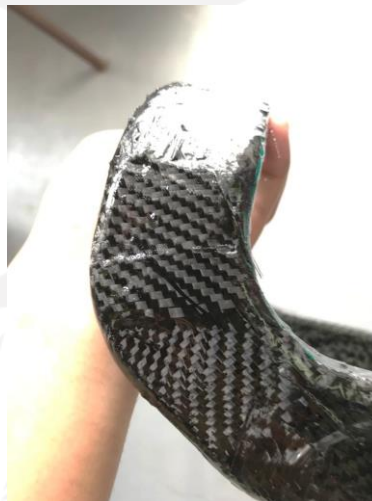
Gambar 4.28 Lapisan carbon tidak rata
