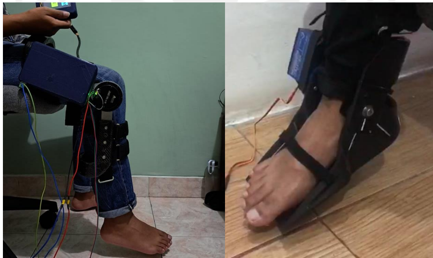
Gambar 4.33 Pengoperasian bagian lutut dan ankle secara terpisah
