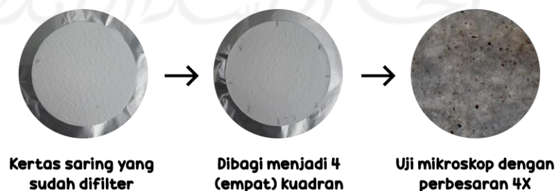
Gambar 3.8 Perlakuan Kertas Saring Untuk Uji Mikroskop
