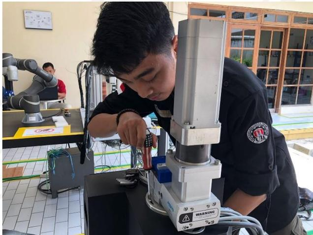
Gambar 4. 13 Perakitan *Rotary Module* ke *Workstation*
