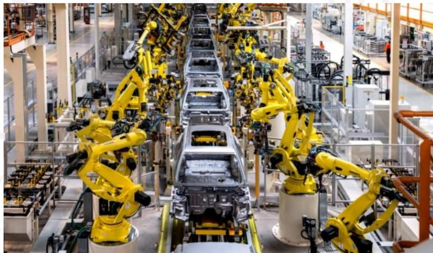
Gambar 2.5 Penerapan Arm Robot di Industri Otomotif
