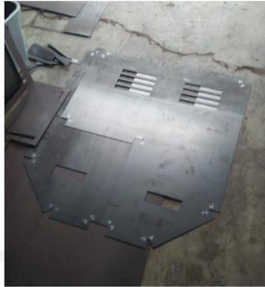
Gambar 4. 6 Sheet Metal Setelah melalui *Laser Cutting*
