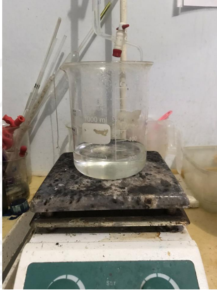
Gambar L-4.1 Larutan Polypropylene dan NaOH setelah diaduk
