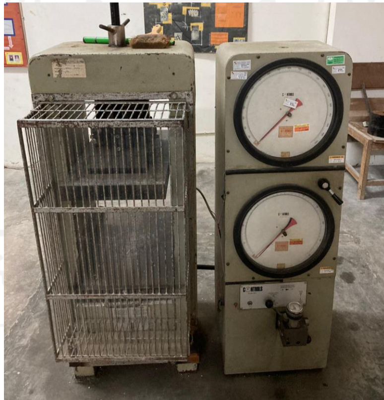
Gambar L-3.8 Mesin Kuat Tekan Beton
