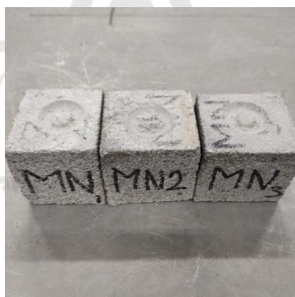
Gambar L-2.21 Benda Uji Setelah Pengujian Keausan
