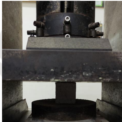
Gambar L-2.17 Pengujian Kuat Tekan Paving Block
