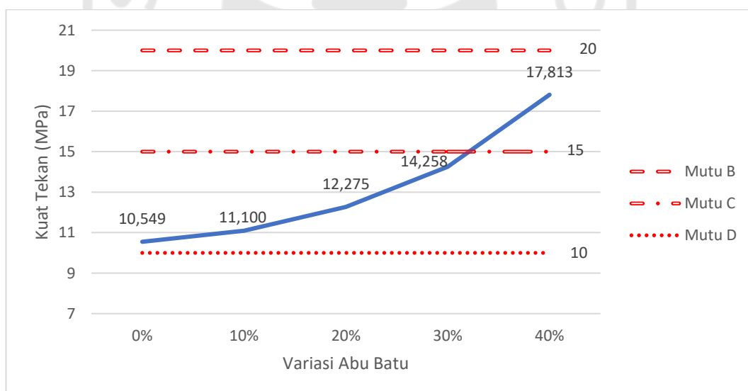
Gambar 5.3 Kuat Tekan Rerata Metode Mekanis
