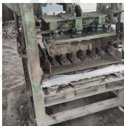
Gambar L-2.12 Pencetakan Paving Block Metode Mekanis
