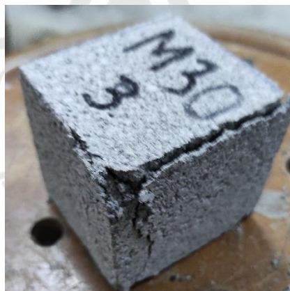
Gambar L-2.18 Benda Uji Setelah Pengujian Kuat Tekan
