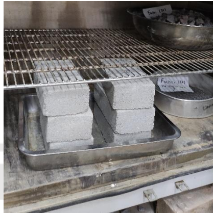
Gambar L-2.19 Pengujian Penyerapan Air Paving Block
