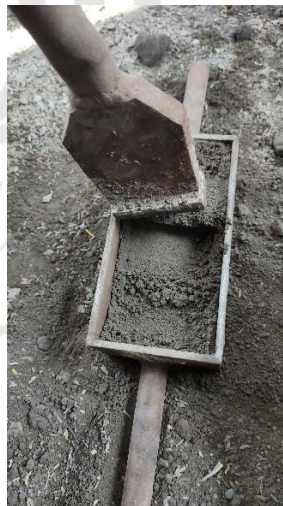
Gambar 3.2 Pencetakan Metode Konvensional
