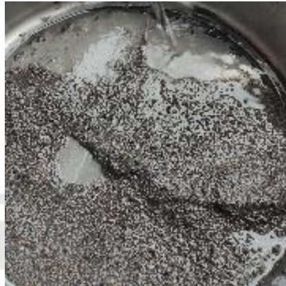
Gambar L-2.10 Pengujian Kadar Lumpur Agregat Halus
