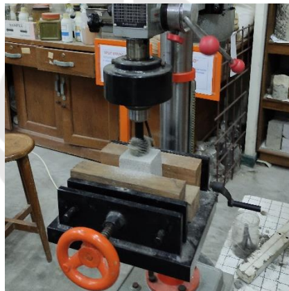
Gambar L-2.20 Pengujian Keausan Paving Block
