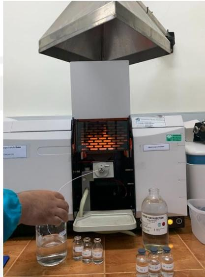
Gambar 4. 5 Proses Analisis Hasil Destruksi Basah Sampel Kertas Filter TPA Piyungan
