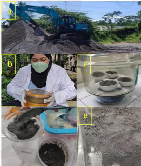
Gambar 5. (a) Area Batu Gajah, (b) Proses Pengayakan Pasir Merapi, (c) Pasir Merapi dalam Desikator, (d) Penyaringan Katalis Pasir Merapi, (e) Katalis Pasir Merapi
