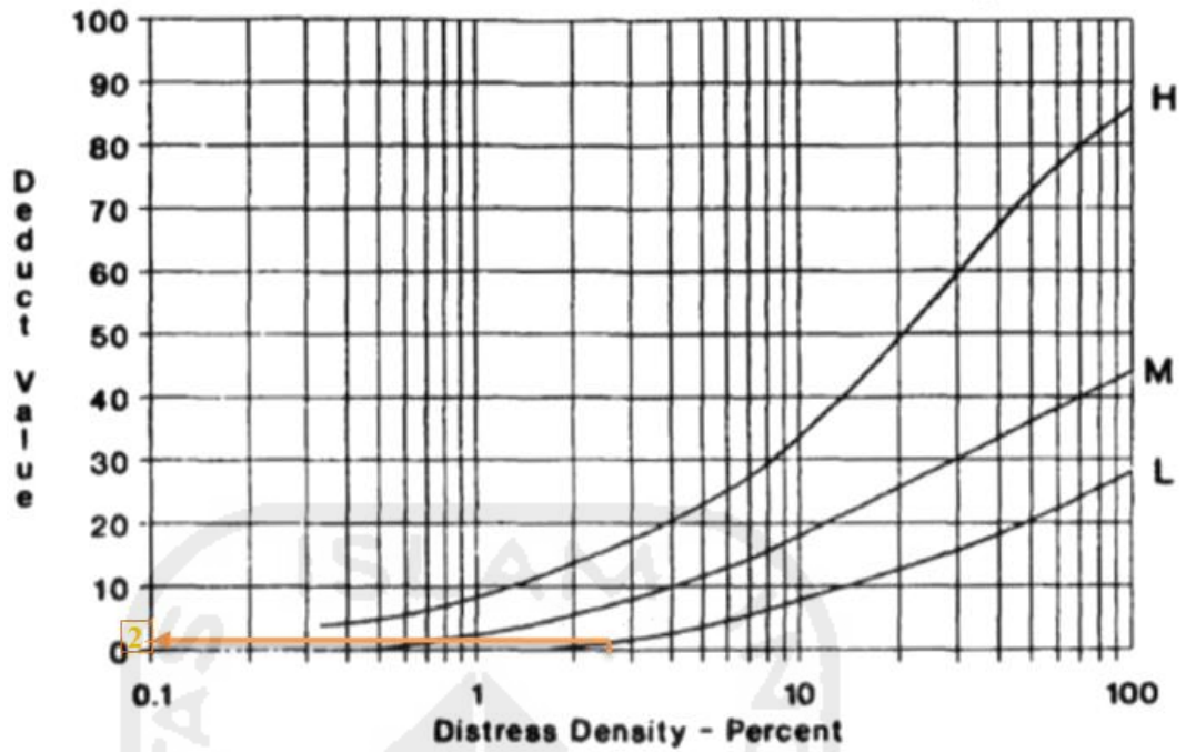
Retak Memanjang dan Melintang (satuan meter)
