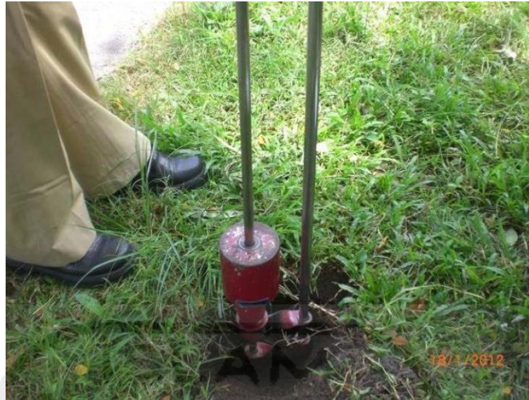
Gambar 4.1 Pengujian DCP (Sumber: Wiyono, 18/1/2012)
