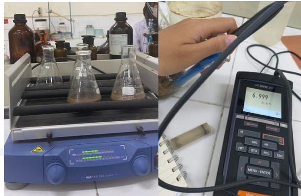
Gambar II.7 Pengujian pH pada Kompos
