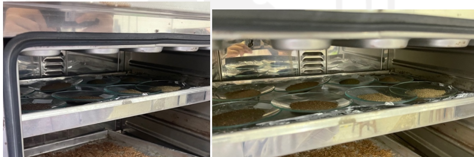
Gambar II.8 Pengujian Kadar Air pada Kompos
