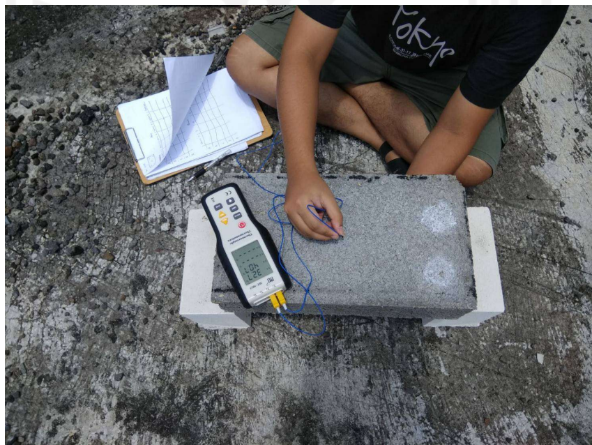
Gambar L-5.1 Pembacaan Suhu Menggunakan Thermocouple
