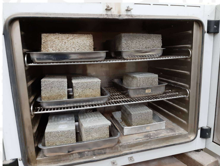
Gambar L-4.4 Pengeringan Benda Uji Menggunakan Oven
