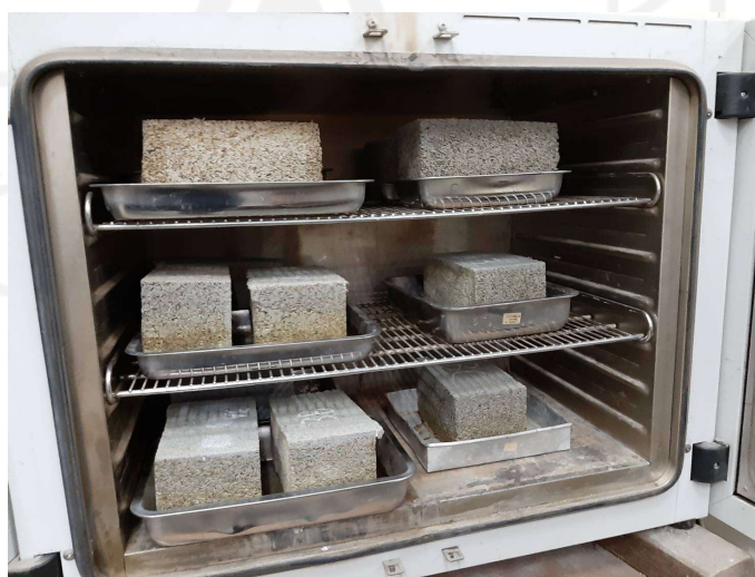
Gambar 4.12 Pengeringan Benda Uji Menggunakan Oven
