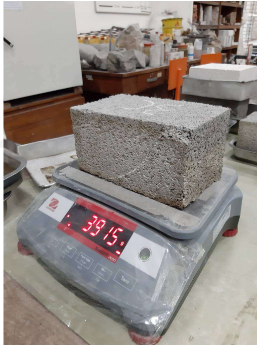
Gambar L-4.5 Penimbangan Benda Uji Setelah Pengeringan
