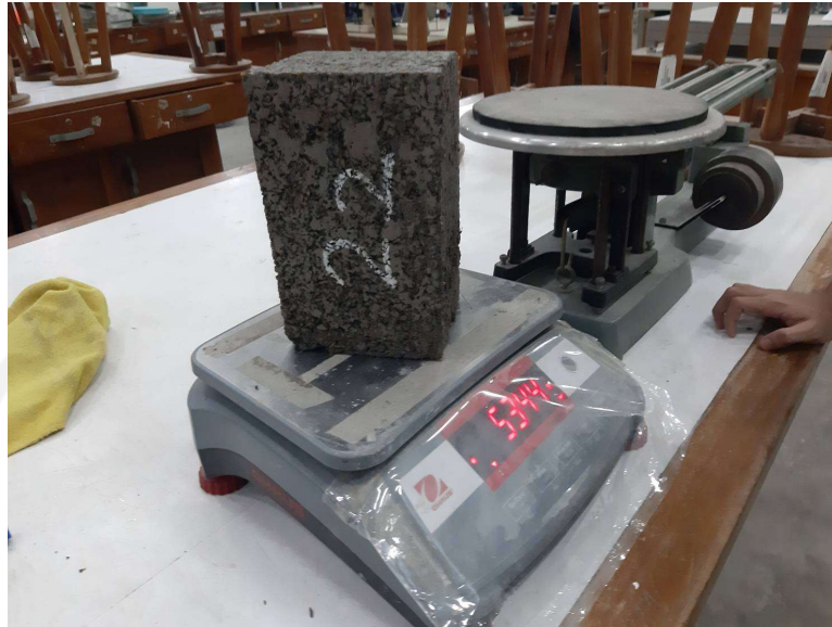
Gambar L-4.3 Penimbangan Benda Uji Setelah Perendaman
