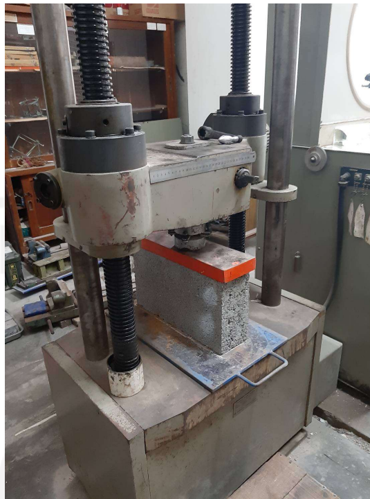
Gambar 4.10 Posisi Benda Uji pada Alat Uji Desak
