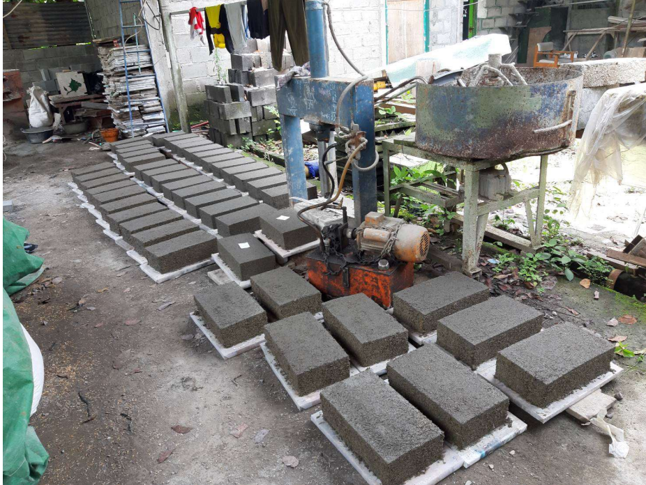
Gambar L-2.1 Benda Uji Setelah Pencetakan
