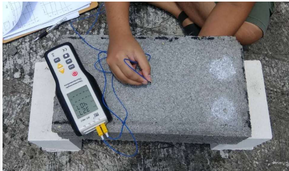
Gambar 4.14 Pengukuran Suhu Batako
