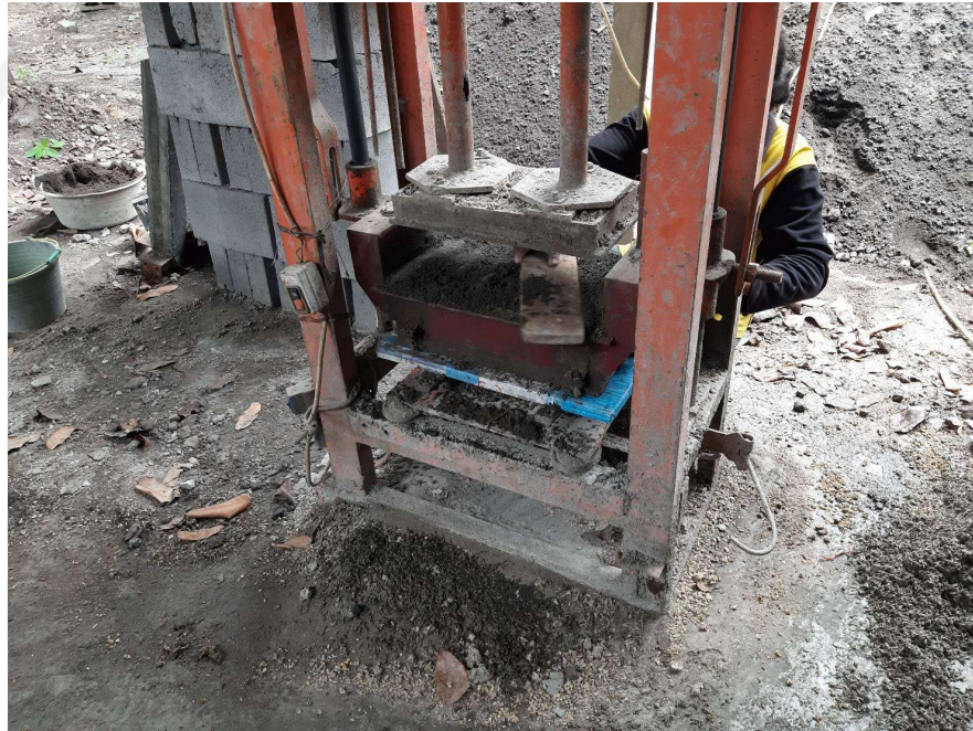
Gambar 4.6 Memasukkan Campuran ke Dalam Cetakan
