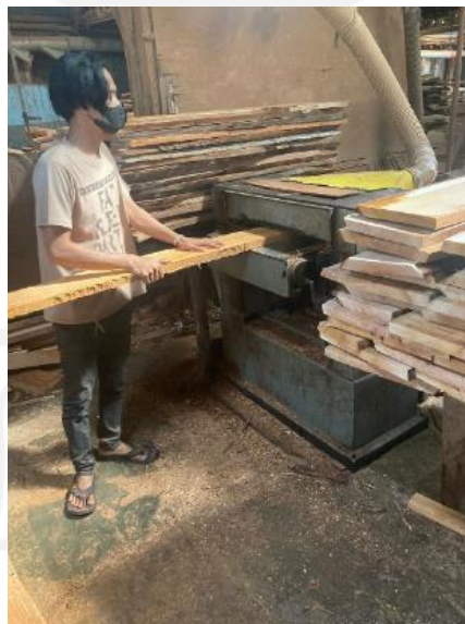
Gambar 4.3 Pekerjaan Membersihkan Permukaan Kayu Menggunakan Mesin Serut
