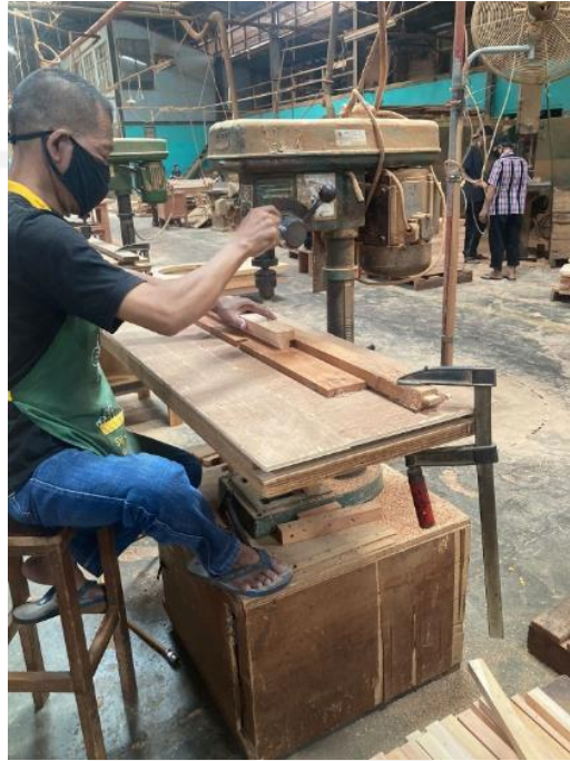
Gambar 4.8 Menunjukkan Pekerjaan Menggunakan Bor
