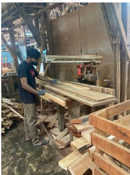
Gambar 4.5 Pekerjaan Memotong Tegak Atau Miring Menggunakan Radial
