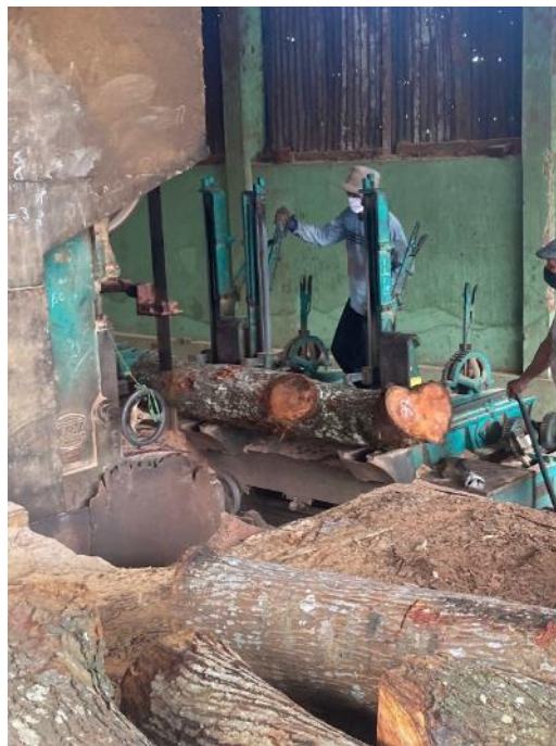
Gambar 4.1 Pekerjaan Pemotongan Kayu Gelondong Menggunakan Saw Mill
