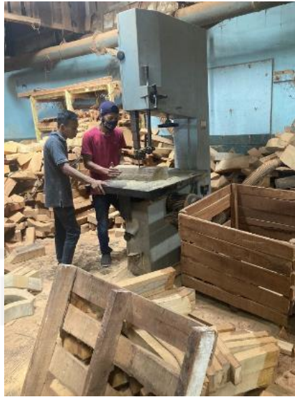
Gambar 4.2 Pekerjaan Merapihkan Dan Memotong Kayu Menggunakan Bandsaw
