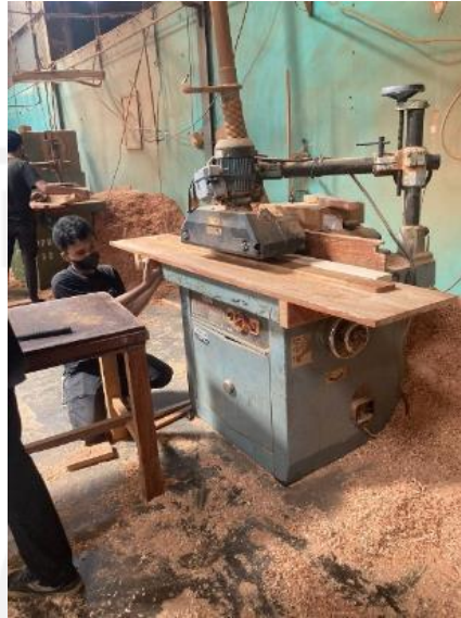
Gambar 4.6 Pekerjaan Membuat Bentuk Khusus Sesuai Pesanan Menggunakan Spindle
