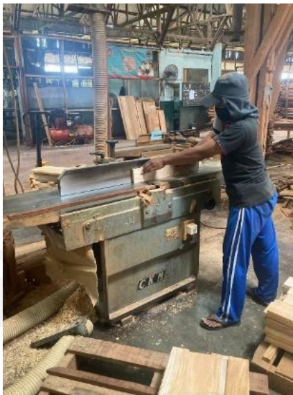
Gambar 4.4 Pekerjaan Meluruskan Permukaan Kayu Menggunakan Jointer
