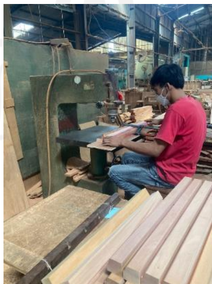
Gambar 4.7 Pekerjaan Membuat Hiasan Pada Kayu Menggunakan Mesin Router
