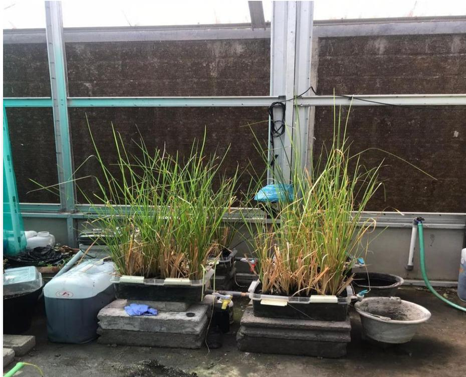
**Gambar 4. 3** Reaktor *Hybrid Constructed Wetland* dan tanaman pada proses running reaktor dilakukan
