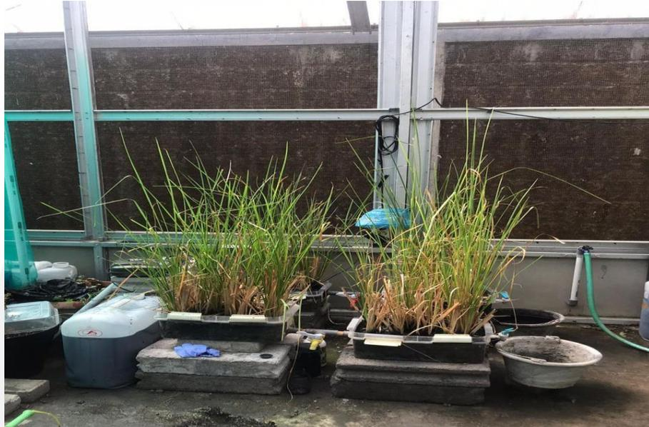
**Gambar 3. 7** Reaktor Vertikal dan Horizontal Wetland
