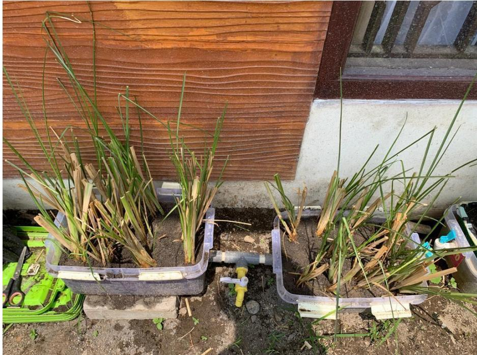
**Gambar 4. 1** Reaktor *Hybrid Constructed Wetland* dan proses pertumbuhan tanaman pada hari ke-7
