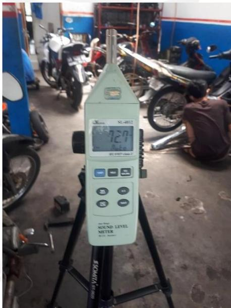
**Gambar 5** Pengukuran Kebisingan menggunakan *Sound Level Meter*
