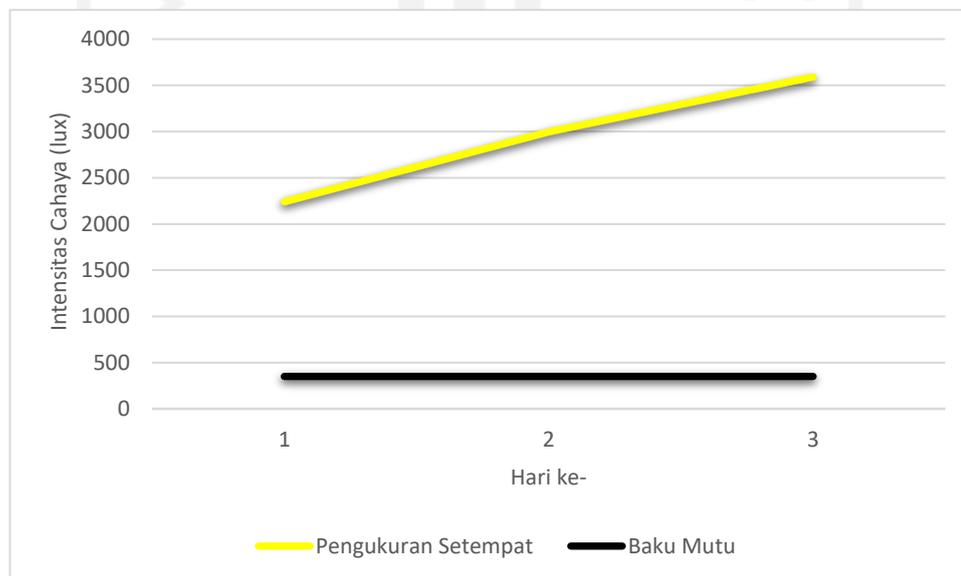
**Gambar 4. 5** Grafik perbandingan baku mutu dengan pengukuran intensitas cahaya setempat selama pengukuran 3 hari
