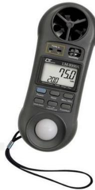
**Gambar 3. 5** *Lux meter* (Alat Pengukur Pencahayaan)
