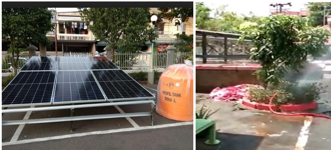
Gambar – 3. Uji Coba Penyedotan Air menggunakan Panel Surya
