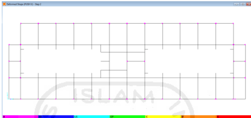
Gambar 5.48 Sendi plastis pada balok lantai 2 Elv +3.2 m pushover arah x step 2
