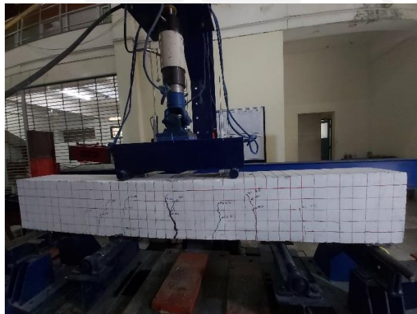
Gambar L-2.9 Kerusakan Benda Uji Balok Coupler Setelah Uji Kuat Lentur
