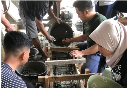
Gambar L-2.4 Pembuatan Benda Uji Balok
