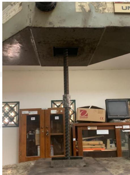
Gambar 5.9 Benda Uji D13 Sambungan Coupler
