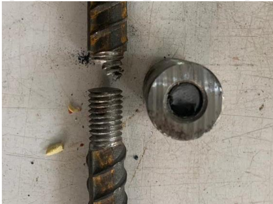
Gambar 4 Kerusakan Baja Tulangan D13 Setelah Pengujian Tarik
