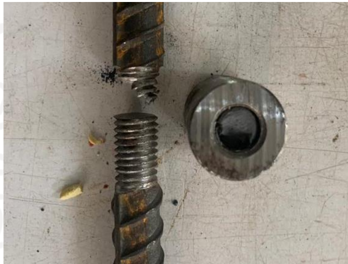
Gambar 5.10 Kerusakan Tulangan D13 Sambungan Coupler Terhadap Uji Tarik
