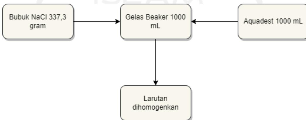
**Gambar 3. 24** Langkah Pembuatan Larutan NaCl
