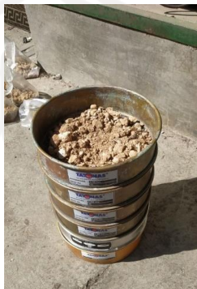
Gambar 3.4 Pengayakan Sampel Tanah
