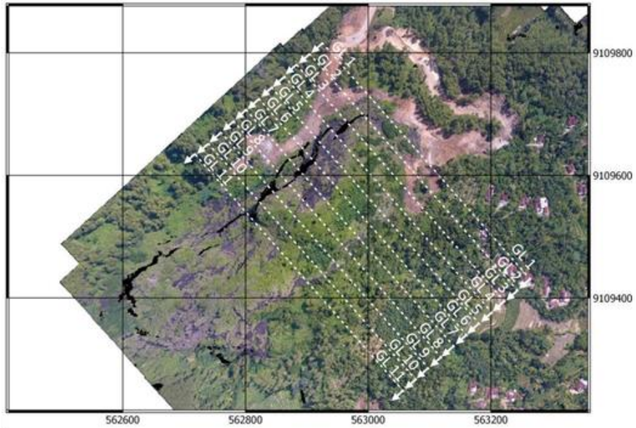
Gambar 5.1 Denah Potongan untuk Perhitungan Volume Gunung Lojah
