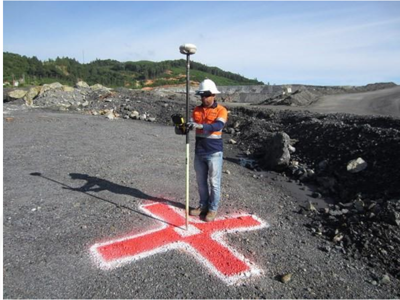
Gambar 5. 28 Benchmarking Ground Control Point dengan Real Time Kinematic GPS
