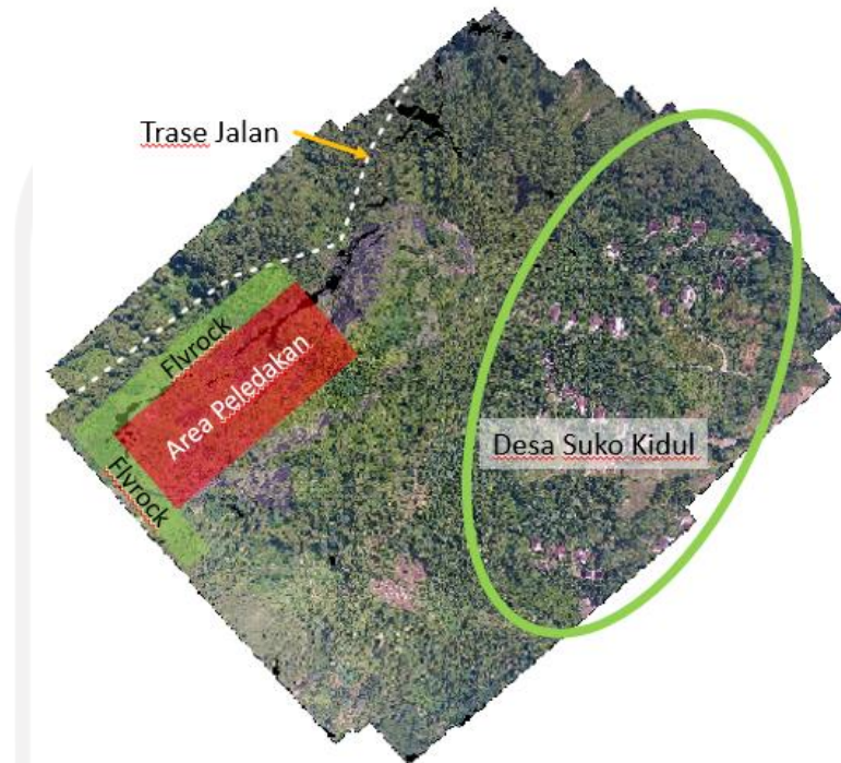
Gambar 5. 6 Skema Perencanaan Peledakan di Gunung Lojeh
