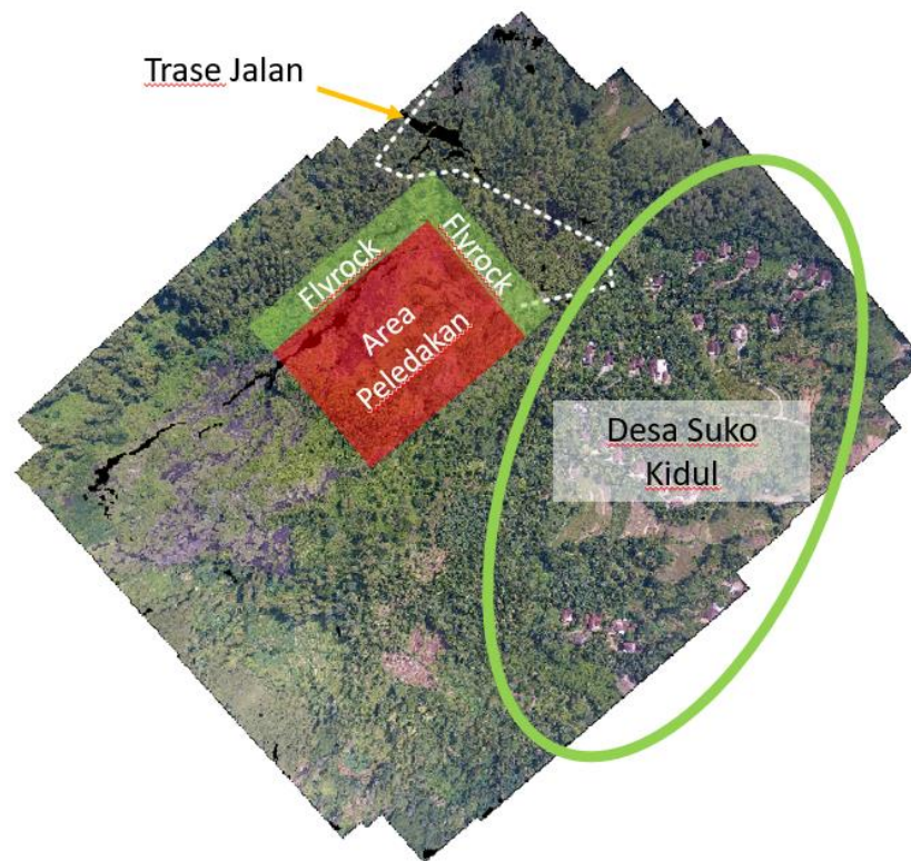
Gambar 5. 9 Skema Perencanaan Peledakan Alternatif Gunung Lojeh
