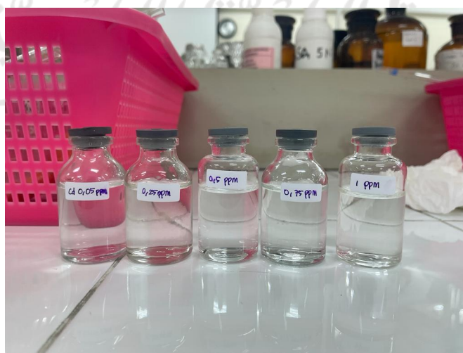
Lampiran 5. Larutan baku Kadmium dengan konsentrasi 0,05 ppm; 0,25 ppm; 0,5 ppm; 0,75 ppm; 1 ppm yang akan dilakukan pengukuran dengan AAS
