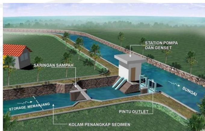
Gambar 3.14 Sistem Polder dengan Instalasi Pompa dan Ruas Saluran sebagai Kolam Tipe Memanjang (Long Storage).
