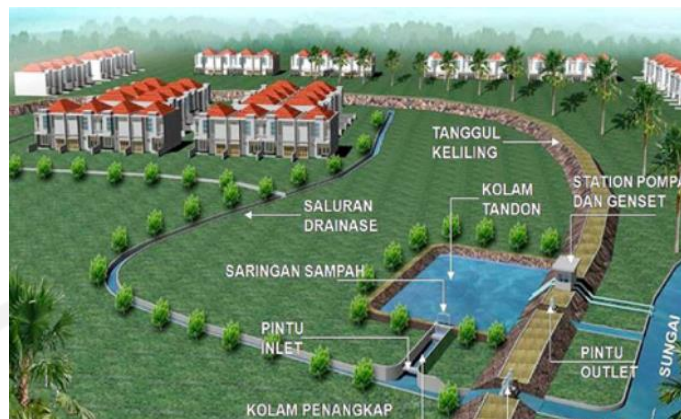
Gambar 3.15 Kolam Retensi yang terletak di samping saluran atau /sungai (Sumber: Kemen PUPR, 2012)
