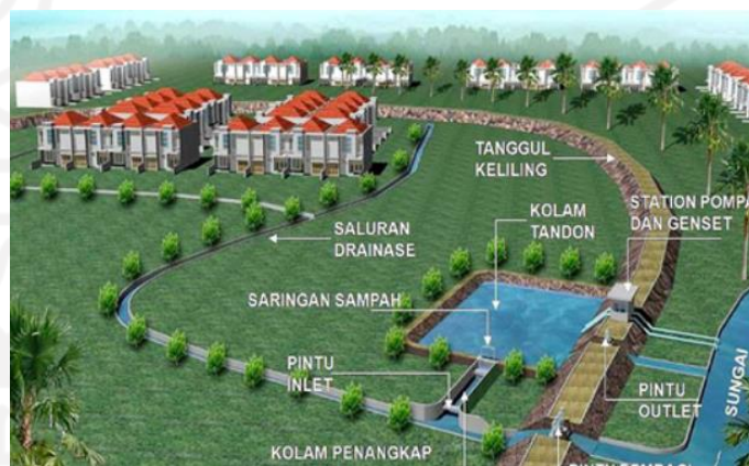
Gambar 3.12 Sistem Polder dengan Instalasi Pompa terletak di samping badan saluran/sungai
