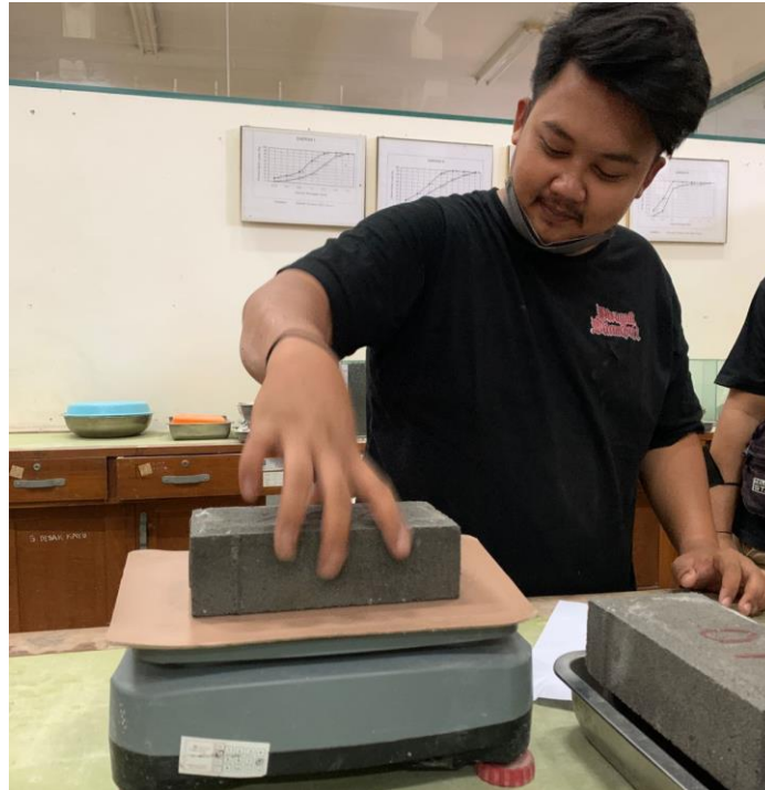
Gambar L-3.3 Penimbangan Penyerapan Air
