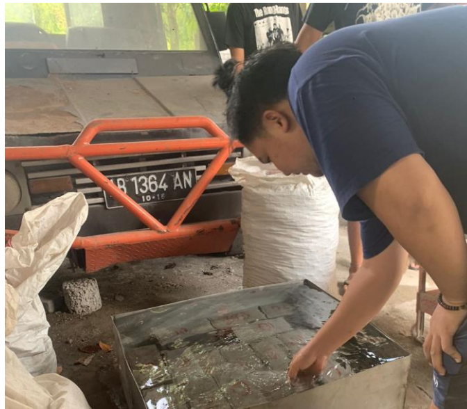
Gambar L-3.1 Perawatan Benda Uji
