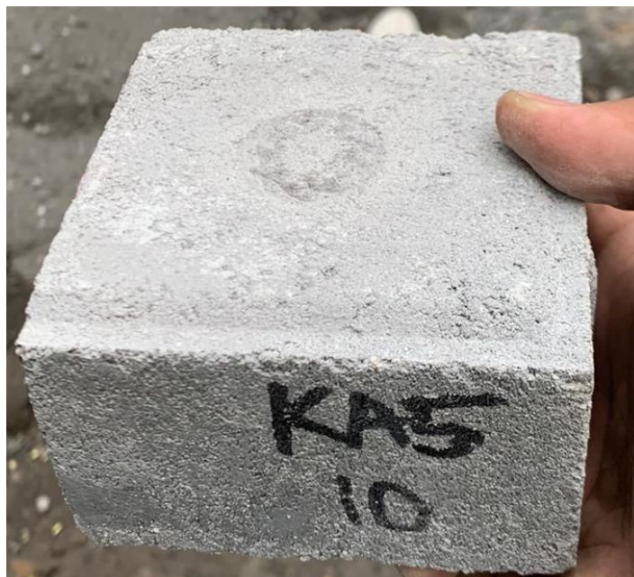
Gambar L-4.2 Hasil Ketahanan Aus variasi 10%
