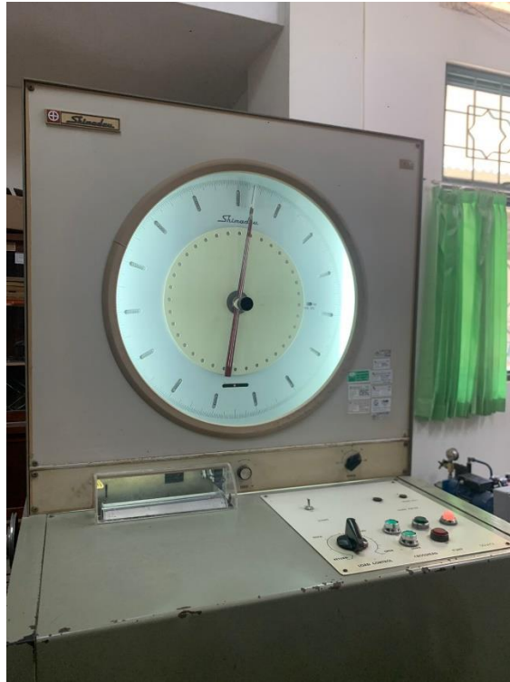
Gambar L-1.9 Mesin Kuat Tekan
