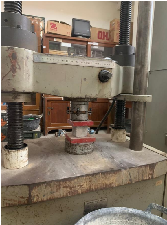
Gambar L-3.5 Pengujian Kuat Tekan
