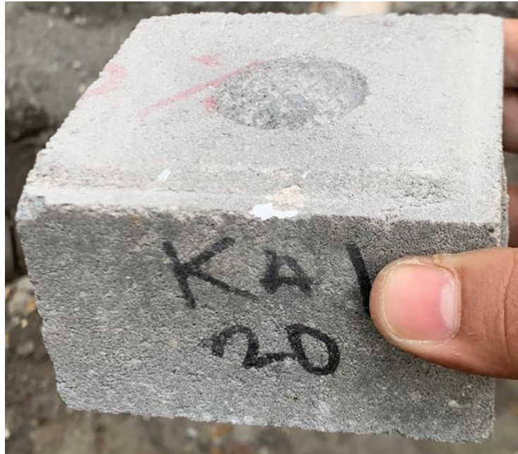
Gambar L-4.3 Hasil Ketahanan Aus variasi 20%
