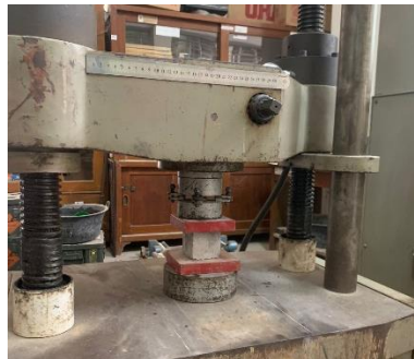
Gambar 4.19 Pengujian Kuat Tekan
