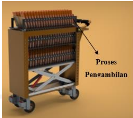
Gambar 4. 52 Mekanisme Pengambilan Genteng
