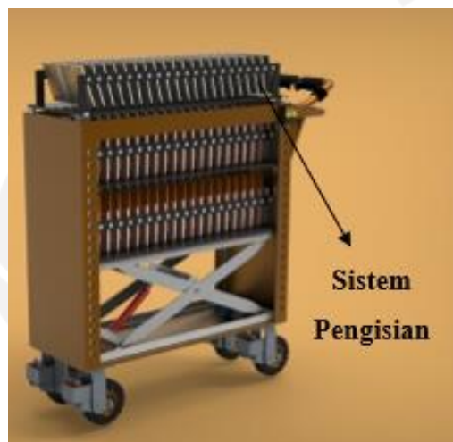
Gambar 4. 53 Mekanisme Sistem Pengisian Genteng
