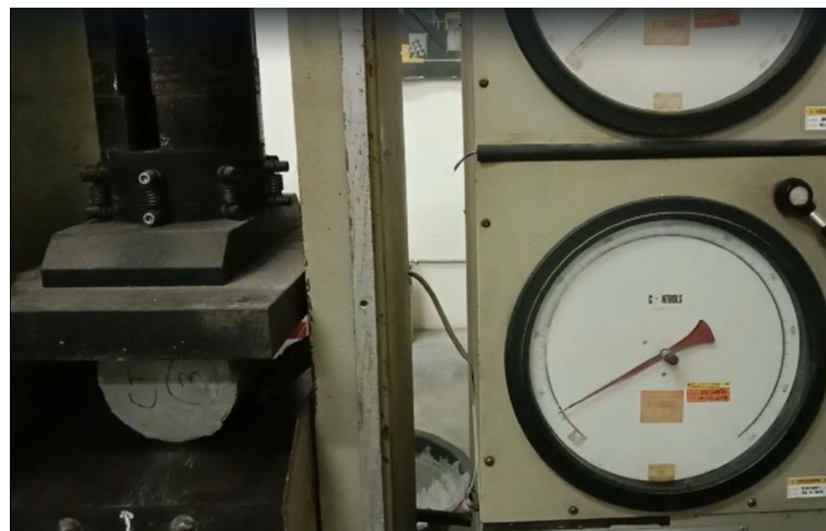
Gambar 5.18 Pengujian Kuat Tarik Belah Beton CT 1
