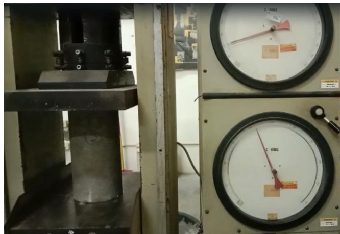
Gambar 5.7 Pengujian Kuat Tekan Beton CT1
