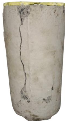
Gambar 5.8 Beton CT1 Setelah Uji Kuat Tekan Beton
