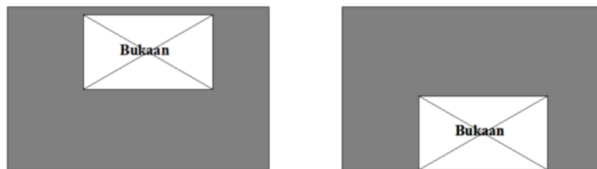
Gambar 3.10 Ketidakteraturan Diskontinuitas Diafragma
