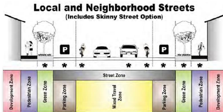
Gambar 2. 3 Potongan Desain Jalan Berdasarkan Klasifikasi Fungsi Sumber: (Milwaukee, 2018)
