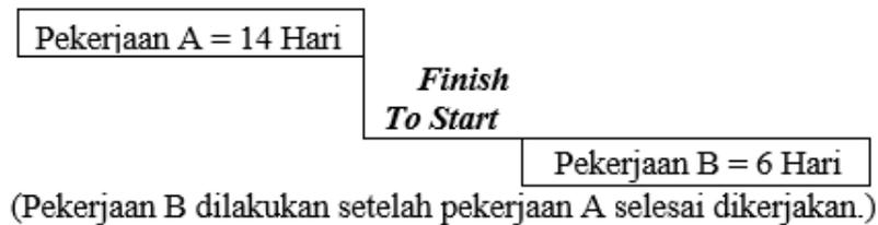
**Gambar 5.25 Pekerjaan Sebelum Dilakukan Percepatan *Fast Track***
