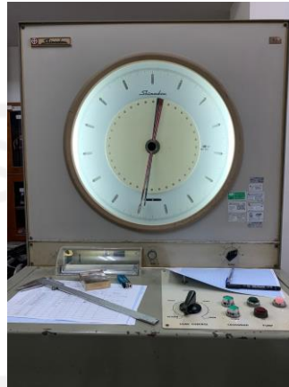
Gambar 4. 11 Universal Testing Machine (UTM) Sumber: Dokumentasi pribadi
