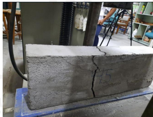
Gambar 5. 4 Benda Uji Setelah Pengujian Kuat Tekan
