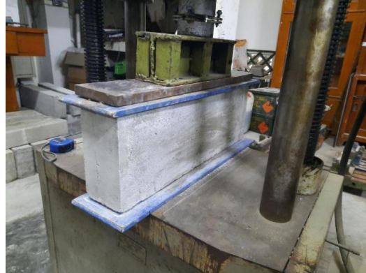
Gambar 5. 3 Setting Up Bata Ringan Untuk Uji Tekan
