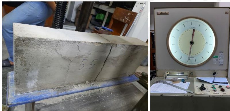
Gambar L-1.12 Pengujian Kuat Tekan Sampel Bata Ringan
