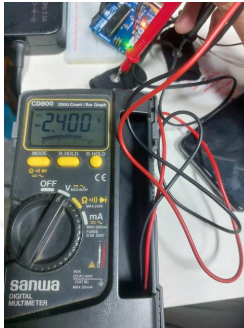
Gambar 5.2 Pengujian dan Hasil Kalibrasi tegangan output GSR menggunakan Multimeter Digital
