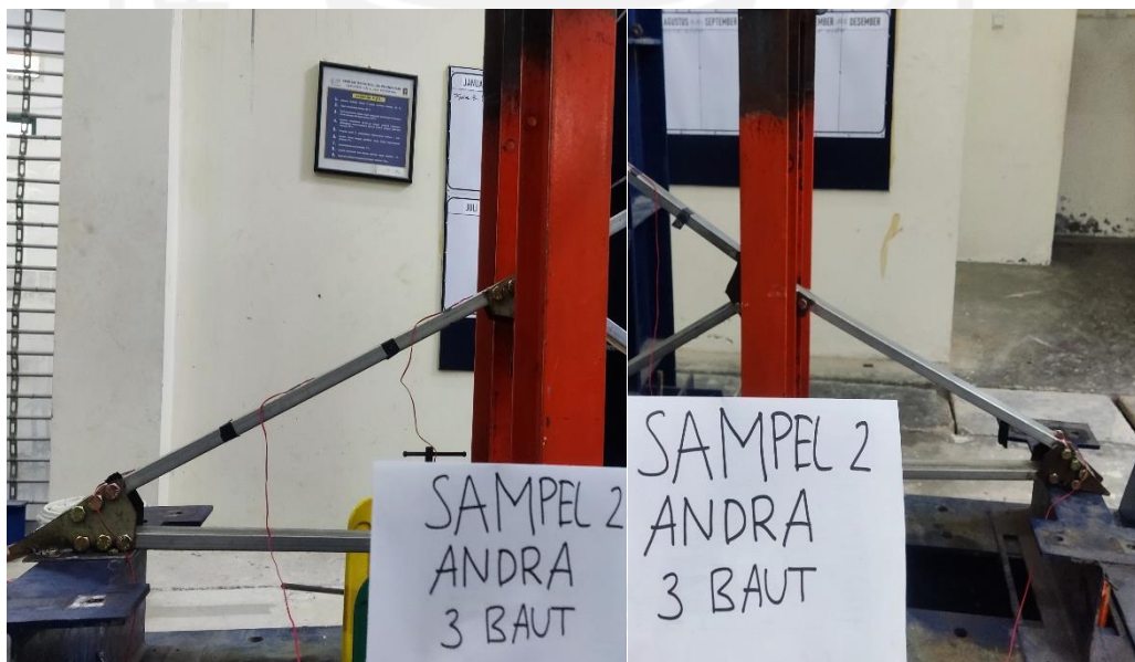
Gambar 5.20 Kondisi Benda Uji Rangka Atap Variasi Jumlah Sambungan 3 Baut Sampel 2
