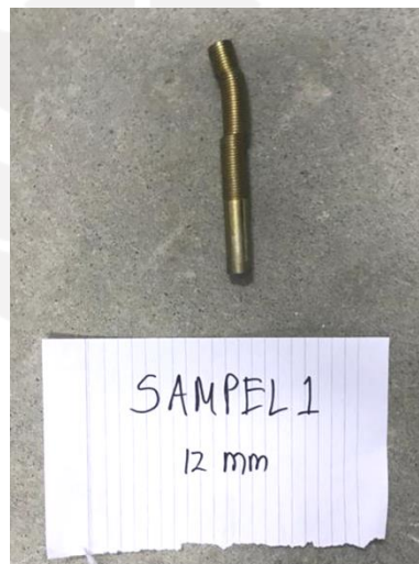
Gambar 5.6 Kondisi Baut Sampel 1 Setelah Pengujian
