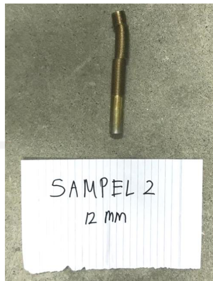
Gambar 5.7 Kondisi Baut Sampel 2 Setelah Pengujian
