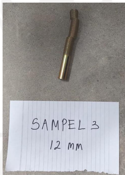
Gambar 5.8 Kondisi Baut Sampel 3 Setelah Pengujian
