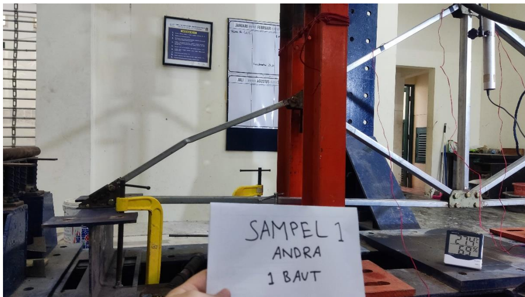
Gambar 5.14 Kondisi Benda Uji Rangka Atap Variasi Jumlah Sambungan 1 Baut Sampel 1
