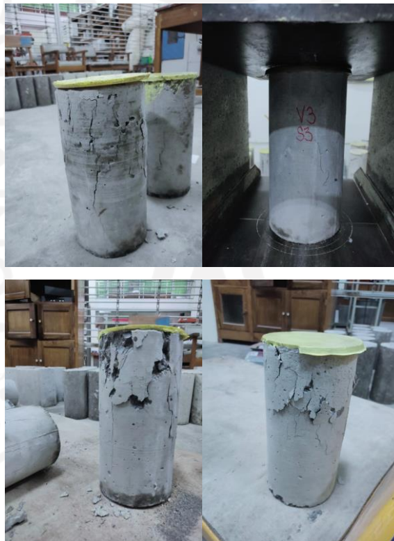
Gambar L-2.13 Benda Uji Setelah Pengujian Kuat Tekan dan Modulus Elastisitas
