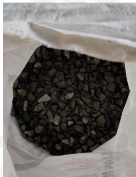
Gambar L-2.3 Agregat Kasar yang Sudah Dicuci
