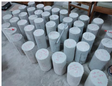
Gambar L-2.10 Proses Pengukuran dan Penamaan Benda Uji
