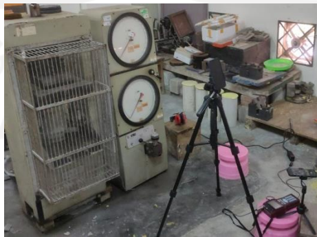
Gambar 5.20 Pengujian Modulus Elastisitas
