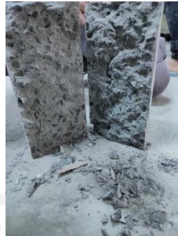
Gambar 5.16 Benda Uji Setelah Pengujian Kuat Tarik Belah
