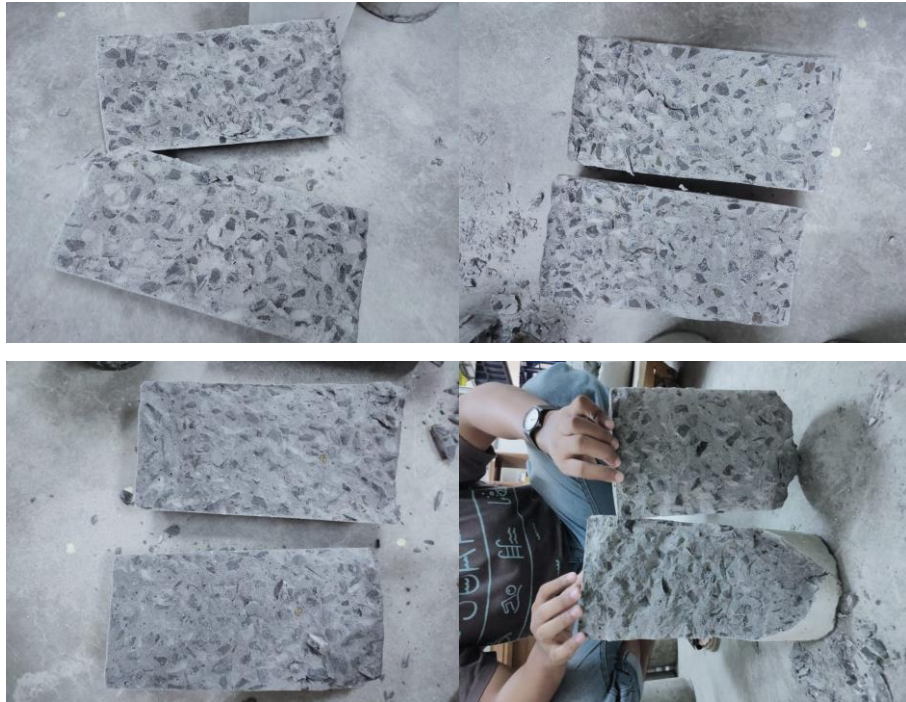
Gambar L-2.14 Benda Uji Setelah Pengujian Kuat Tarik Belah
