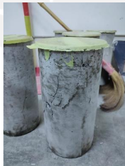
Gambar 5.13 Benda Uji Setelah Pengujian Kuat Tekan
