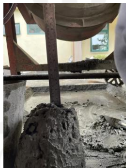
Gambar L-2.7 Proses Uji Slump
