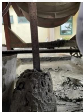
Gambar 5.9 Contoh Pengujian Nilai Slump
