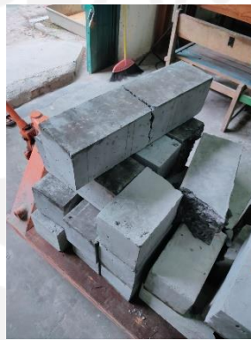
Gambar 5.19 Benda Uji Setelah Pengujian Kuat Lentur
