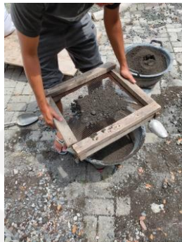
Gambar L-2.2 Proses Penyaringan Agregat Halus
