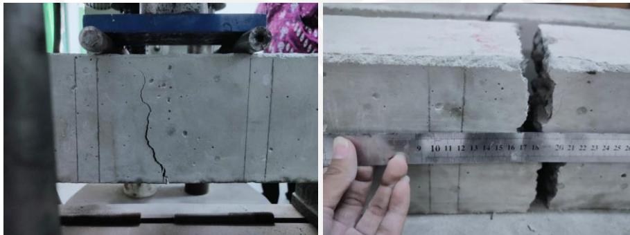
Gambar L-2.15 Benda Uji Setelah Pengujian Kuat Lentur
