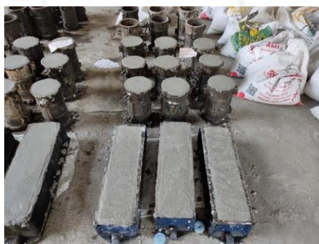
Gambar L-2.8 Proses Pematatan Campuran Beton Pada Cetakan
