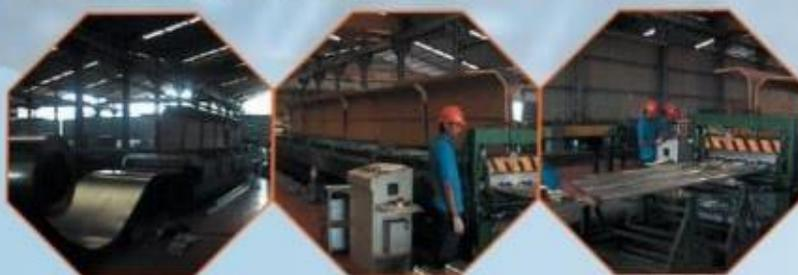
Profil Union Floor Deck W-1000® dibuat menggunakan mesin pembentuk buatan Australia.
